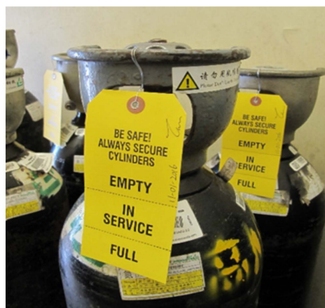
有黄色的气瓶状态标识卡 Empty , In service , Full
